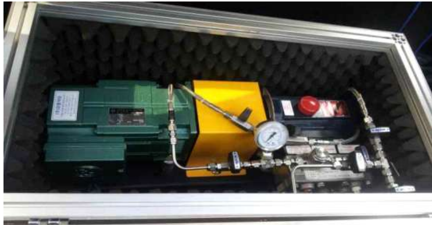
그림 14 암모니아 연료 공급 펌프
